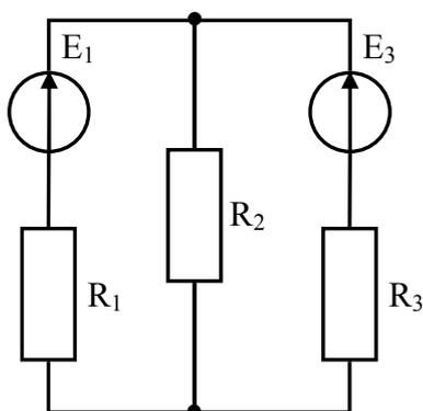
4. Используя метод контурных токов, определить токи в ветвях схемы, изображенной на рисунке 2, если  $E_1 = 4$  В,  $E_3 = 6$  В,  $R_1 = 20$  Ом,  $R_2 = 40$  Ом,  $R_3 = 20$  Ом.
