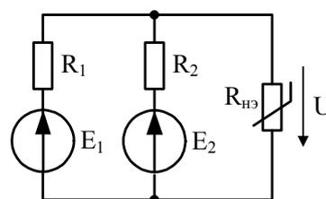
13. В цепи постоянного тока, изображенной на рисунке,  $R_1 = R_2 = 6 \text{ Ом}$ ,  $E = 12 \text{ В}$ . Симметричная ВАХ нелинейного элемента задана в виде таблицы. Определите напряжение на НЭ  $U$ .
